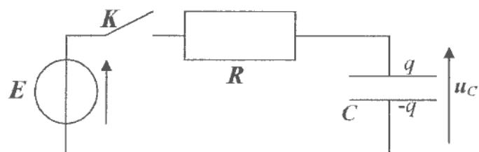
L'équation différentielle vérifiée par la tension  $u_C$  aux bornes du condensateur peut se mettre sous la forme :
